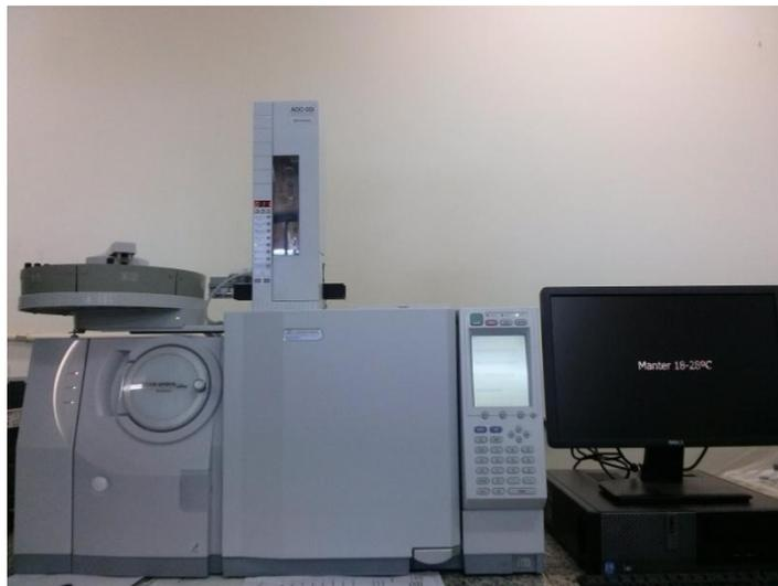
**Figura 1.** Equipamento de cromatografia gasosa acoplada ao espectro de massa utilizado durante as atividades de estágio
