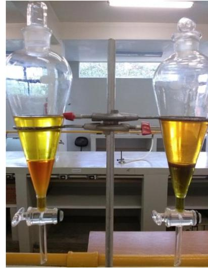
**Figura 5.** Etapa de separação de fases realizada após a transesterificação
