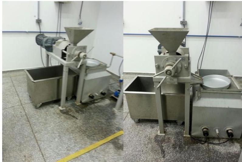
**Figura 2.**Sistema de prensa hidráulica utilizada para a extração dos óleos de Cambre e Nabo Forrageiro
