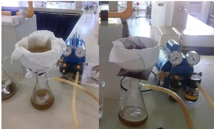
**Figura 3.** Filtração dos óleos de Cambre e Nabo Forrageiro
