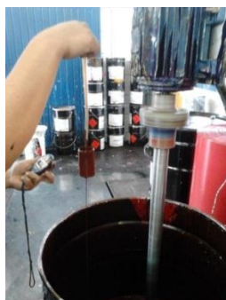
Figura 12- Representação de uma análise de viscosidade em tinta.
