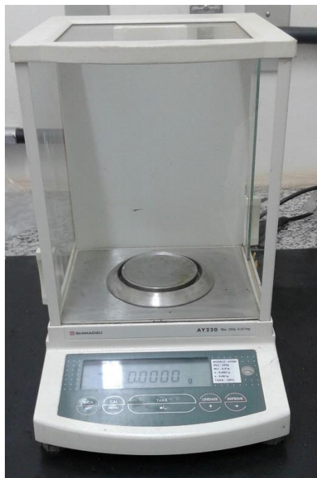
Figura 8 – Balança analítica Shimadzu com precisão de 0,0001 gramas do laboratório CPBio.
