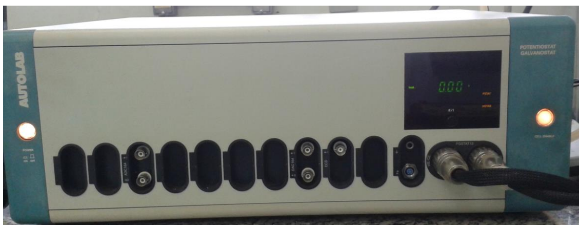
Figura 8: Potenciostato-galvanostato AUTOLAB PGSTAT-12.
