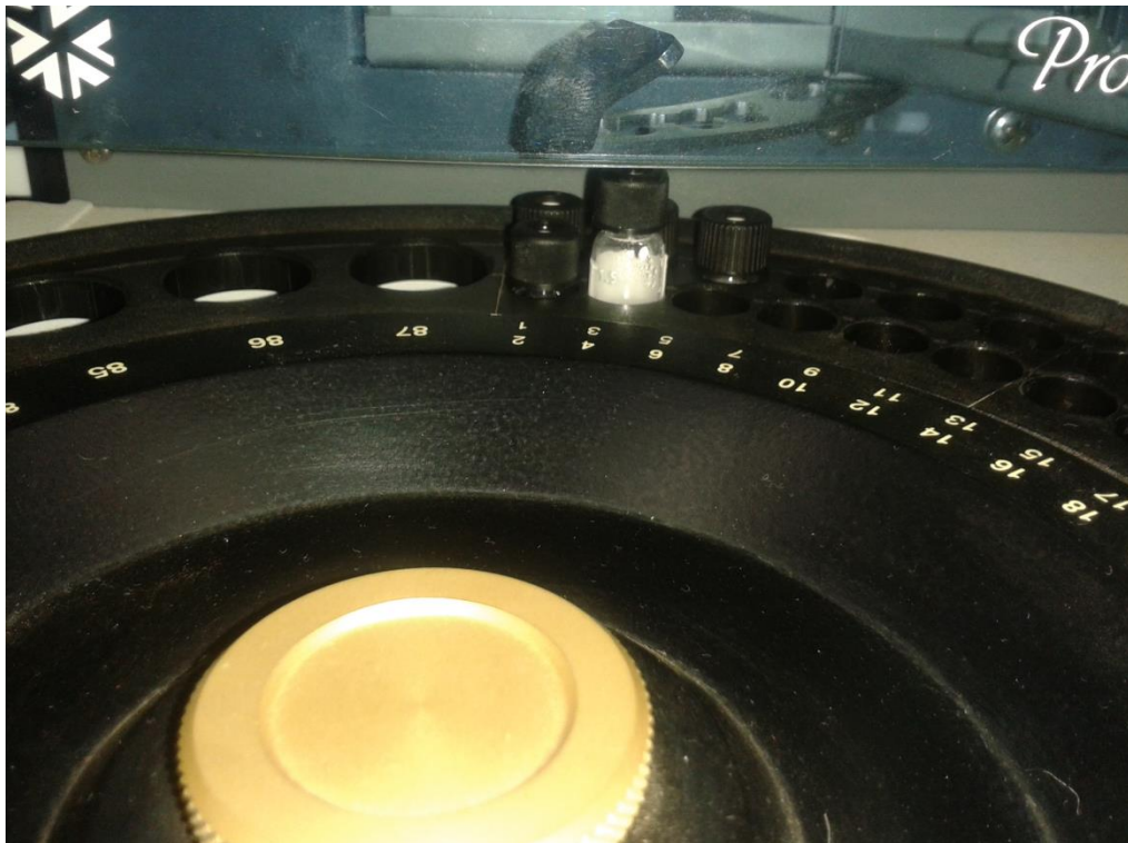
Figura 10 – Injeção das amostras no CLAE.
