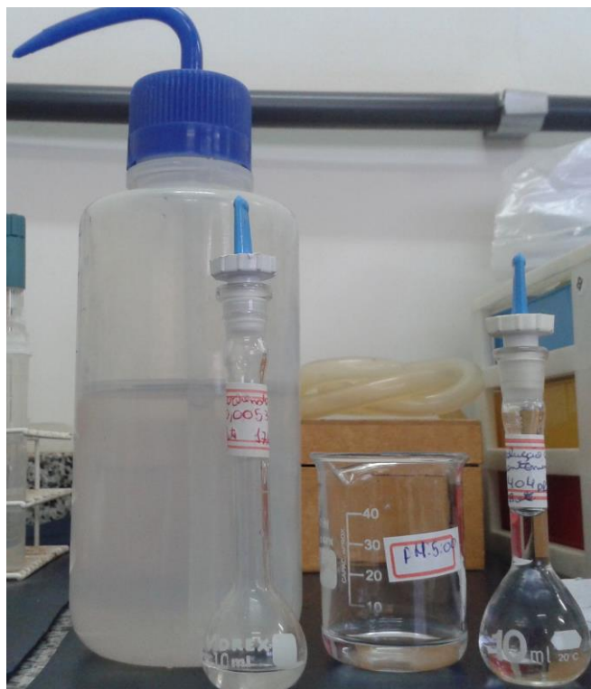
Figura 7: Preparo da amostra de água destilada contaminada com Carbendazim.
