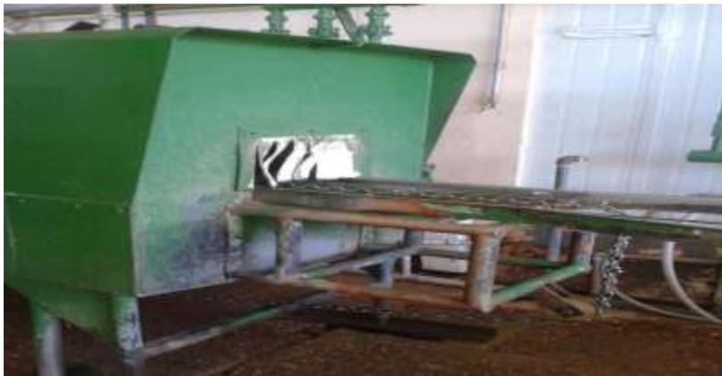
**Figura 21** - Máquina que lava as bandejas onde coloca-se o leite já embalado. Laticínios Camby.
