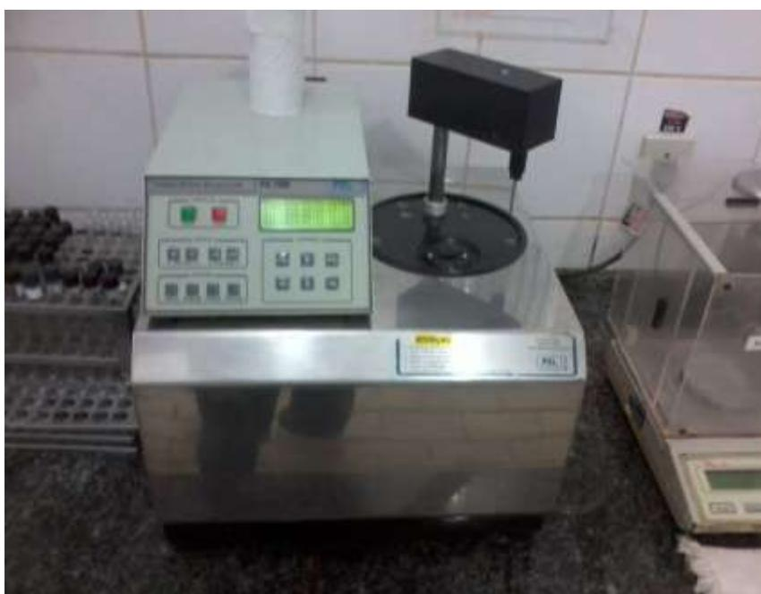
**Figura 10** - Crioscópio Eletrônico. Laboratório Laticínios Camby.
