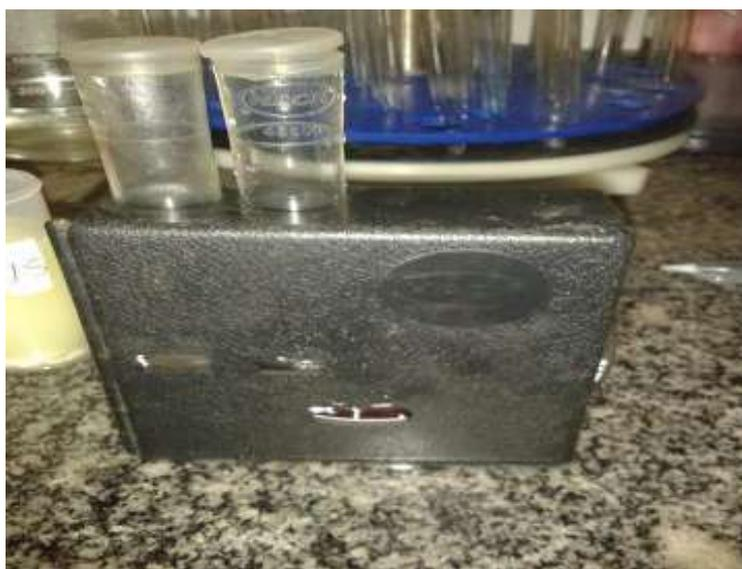
**Figura 18** – Aparelho para teste de cloro. Laboratório Laticínios Camby.
