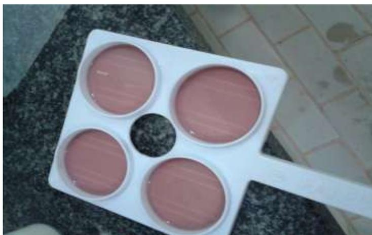
**Figura 8** - Teste do alizarol na raquete, em laboratório, para maior agilidade. Foto tirada no laboratório do Laticínio Camby.
