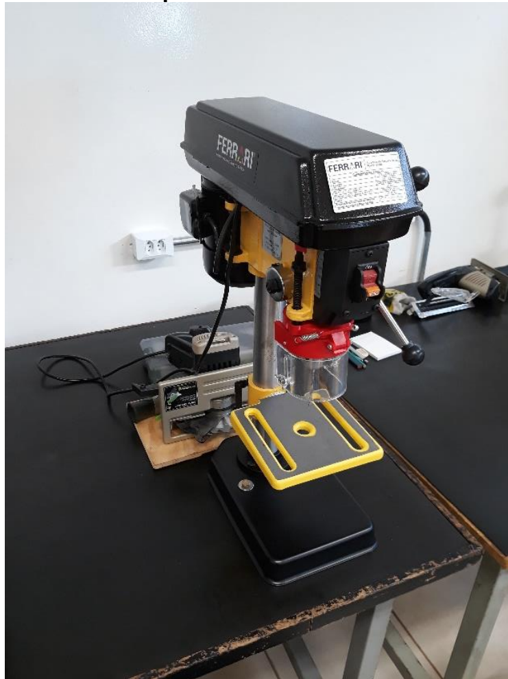
Figura 30 – Furadeira de bancada FERRARI FG-13 de 250W de potência Furadeira de Bancada.
