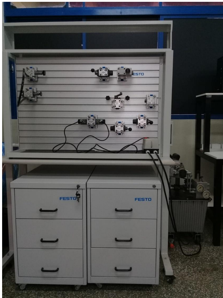
Figura 23 – Bancada de treinamento em Hidráulica / Eletrohidráulica FESTO
