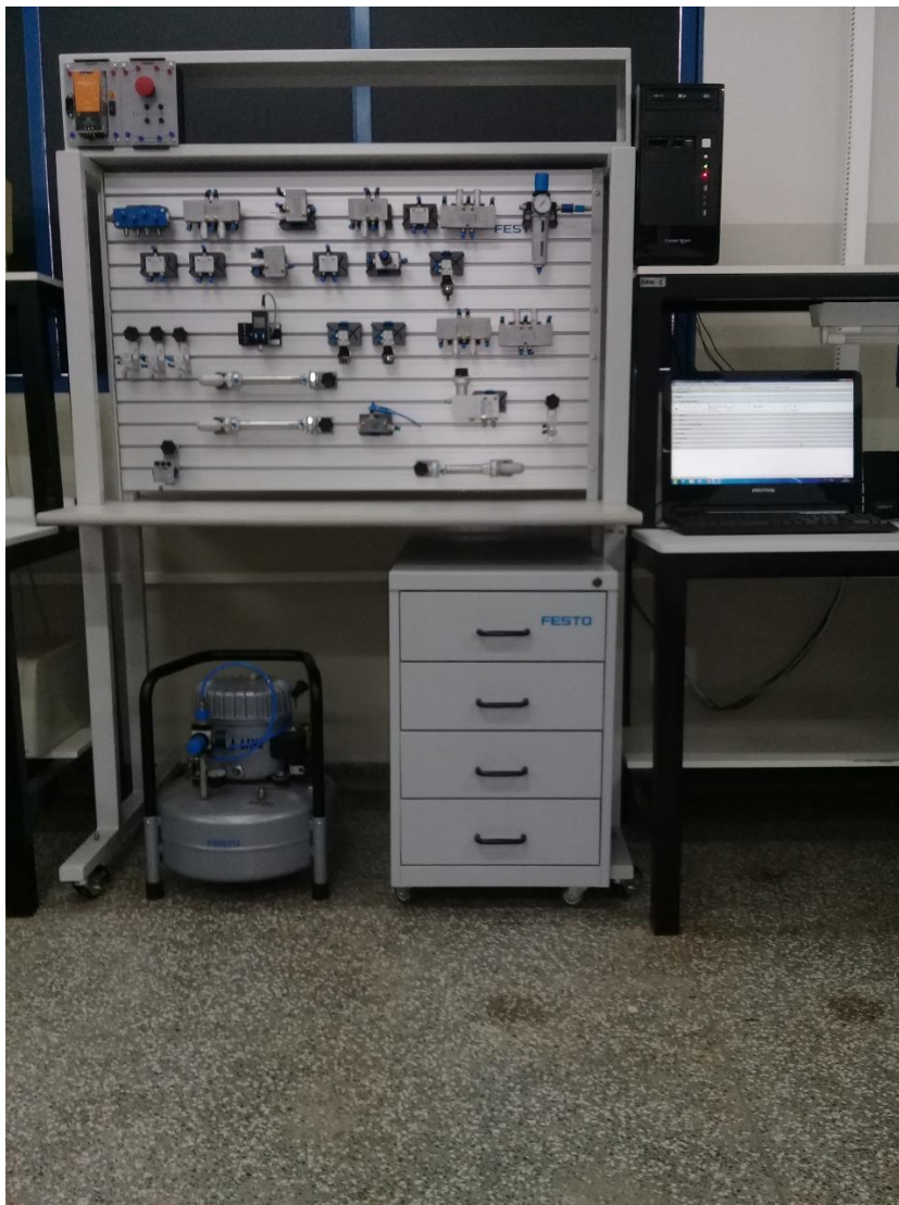
Figura 22 – Unidade de treinamento em pneumática / eletropneumática da marca FESTO
