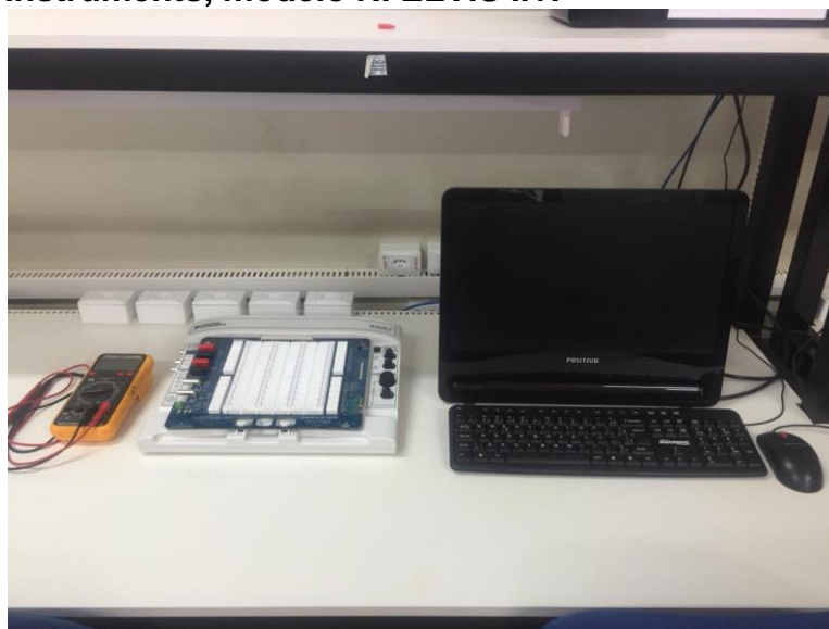
Figura 24 – Kit de Eletrônica/Plataforma Integrada de Instrumentos Virtuais da marca National Instruments, modelo NI ELVIS II+.
