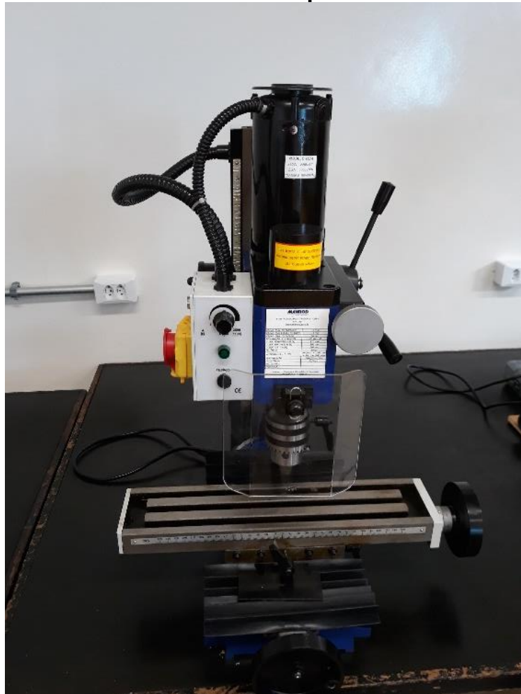
Figura 29 – Mini furadeira fresadora profissional Manrod MR220 de 350 W de potência.
