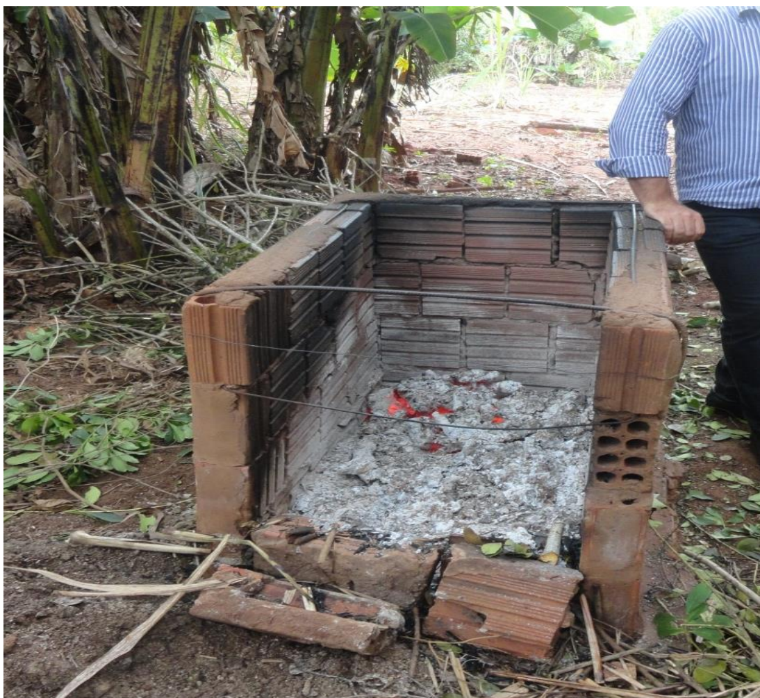
Figura 5 - Armação onde é feito o sapeco manual da erva-mate Indústria A9 Fonte: Elaboração própria com base nos dados da pesquisa, (2016).
