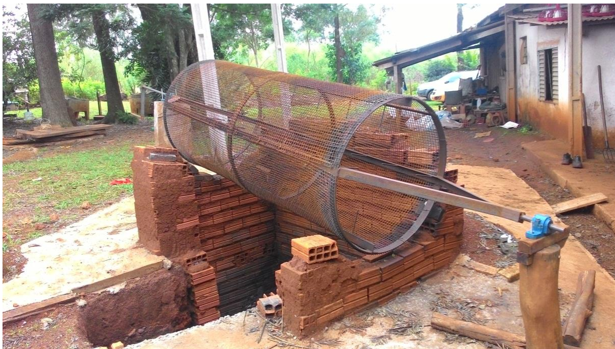
Figura 10 - Cilindro onde é feito o sapeco mecânico da erva-mate Indústria A10 Fonte: Elaboração própria com base nos dados da pesquisa, (2016).
