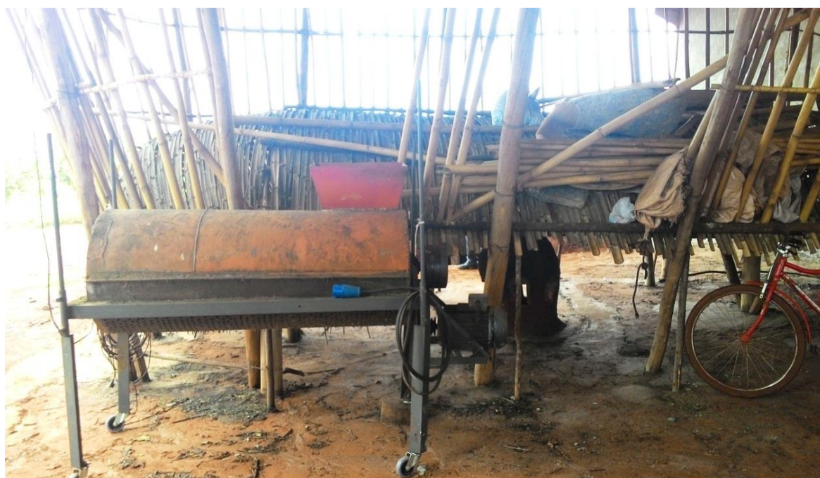
Figura 12 - Tritador e peneira da erva-mate Fonte: Elaboração própria com base nos dados da pesquisa, (2016).
