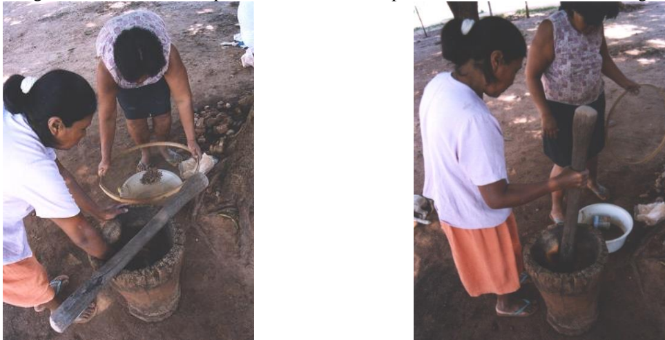
Imagem 10: Artesãs Terena peneirando e socando o pó cerâmico a ser adicionado à argila
