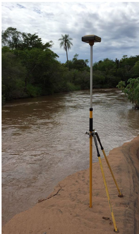
Figura 2 Obtenção de Ponto de Controle Altimétrico a Campo (GCP) a partir de GPS Topcon HiPer L1, Rio Dourados, 2017.
