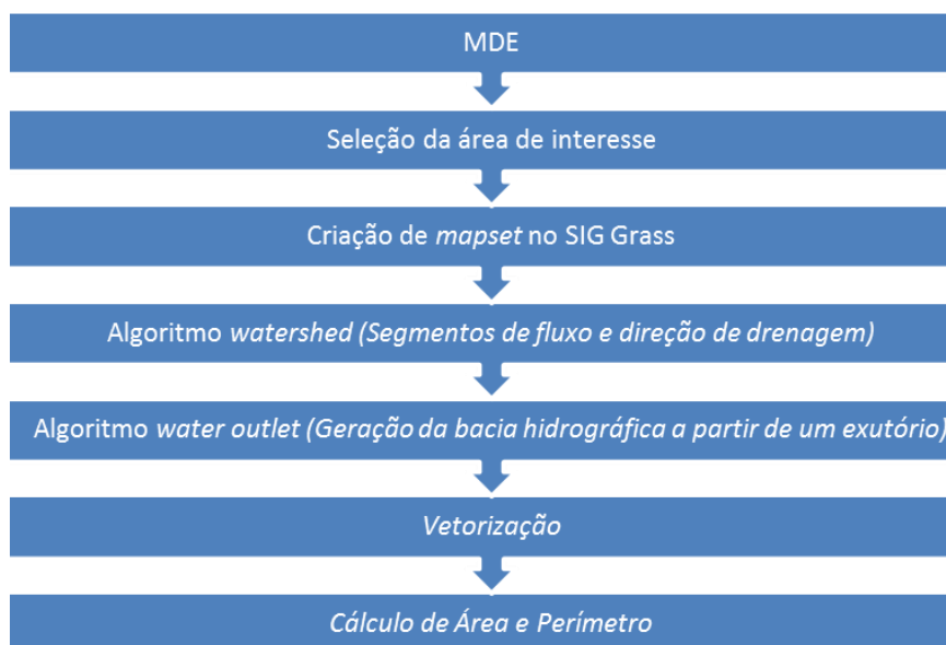
Figura 4 Fluxograma para delimitação de bacia hidrográfica pelo Quantum Gis 2.18.13 (QGIS DEVELOPMENT TEAM, 2017).
