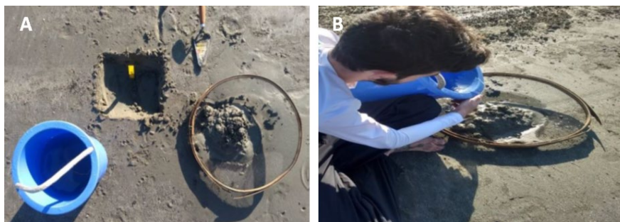
Figura 9.2 – A) Quadrante escavado e B) água despejada na areia para sobrar os pellets . Fonte: Arquivo pessoal (2019).
