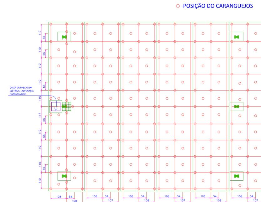
**DETALHE DE POSICIONAMENTO DAS BARRAS DE TRANSFERÊNCIA DE CARGA ENTRE PLACAS DO PISO**
