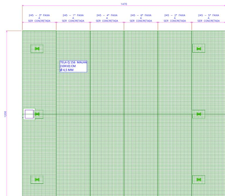
**DISPOSIÇÃO ARMADURA TRANSFERÊNCIA DE CARGA**
