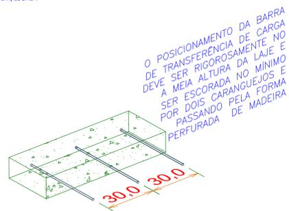
**POSICIONAMENTO DAS BARRAS DE TRANSFERÊNCIA DE CARGA**
