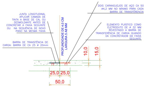
**JUNTA SERRADA - JUNTA TRANSVERSAL E LONGITUDINAL ENTRE FAIXAS**
